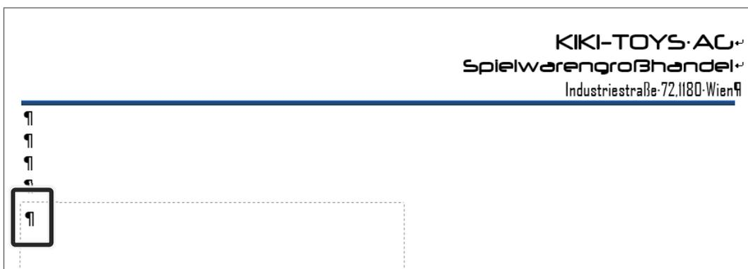
Der Positionsrahmen wird standardmäßig erst dann sichtbar, wenn Sie innerhalb des Rahmens klicken.
